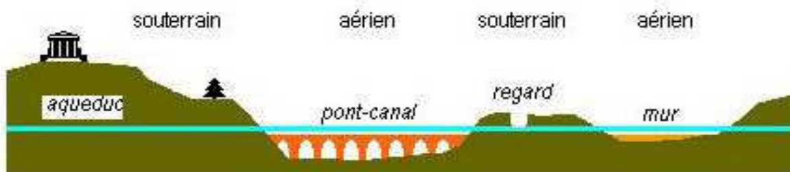
Fig. 2.19 : l'aqueduc en forme canal, tunnel, mur porteur
